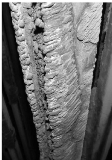
Rys. 5. Wzmożenie procesu żużlowania [9]
