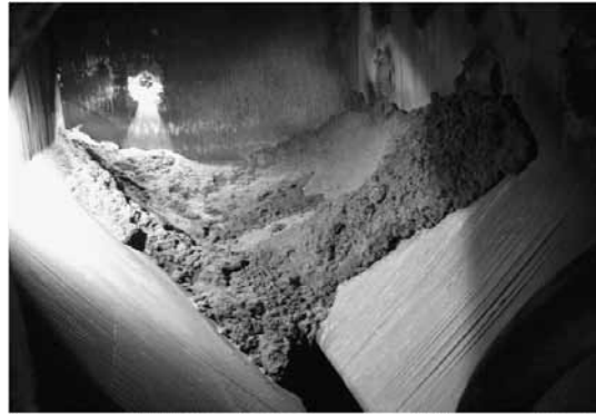
Rys. 6. Zatkany lej odprowadzający [10]
